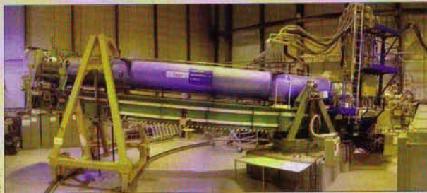
Le télescope Cast du Cern, près de Genève, est pointé vers le Soleil et espère voir tomber un axion dans son tube.
